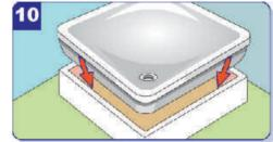
Der Wannenträger wird mit Mörtel/Kleber auf dem Boden befestigt. Die Wanne kann nun in den Wannenträger gestellt und ausgerichtet werden.
