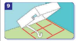
Stahlwannen unbedingt vom Elektriker erden lassen. Zunächst müssen die Durchgänge für den Abfluss und die Revisionsöffnung ausgesägt werden.
