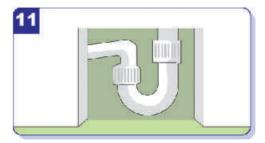
Nach Anschluss des Ablaufes an das Fallrohr und Dichtungsprüfung kann die Erdung der Wanne durch den Elektriker erfolgen.
