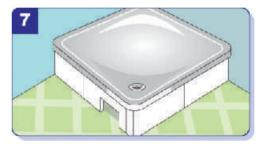
Wannenrand untermauern und unbedingt eine Revisionsöffnung für den Zugang zum Ablauf lassen. (Fliesen- und Kleberdicke berücksichtigen)
