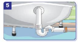
Abfluss mit HT-Rohr am nächsten Fallrohr anschließen. Das Gefälle sollte mindestens 2 cm pro Meter betragen. Nach Anschluss auf Dichtigkeit prüfen.
