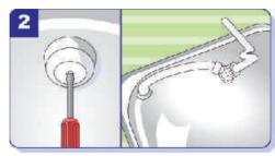
Anschließend wird der Siphon an den Wannenablauf montiert.
