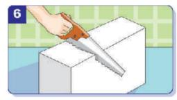
Für die Umkleidung der Duschwanne die Blöcke aus Porenbeton zuschneiden.
