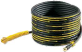
Zur Reinigung von Rohren, Abflüssen, Fallrohren und Toiletten und zur Befreiung von Verstopfung. Vier nach hinten gerichtete Hochdruckdüsen schieben den Schlauch durch das Rohr und lösen so die Blockade. Der flexible 7,5 m lange Qualitätsschlauch ist mit Textilgeflecht, mit einer extra-kurzen Messingdüse für optimale Beweglichkeit im Rohr.
